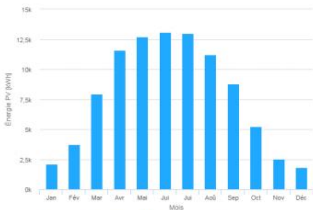
Production énergétique mensuelle du système PV fixe:
